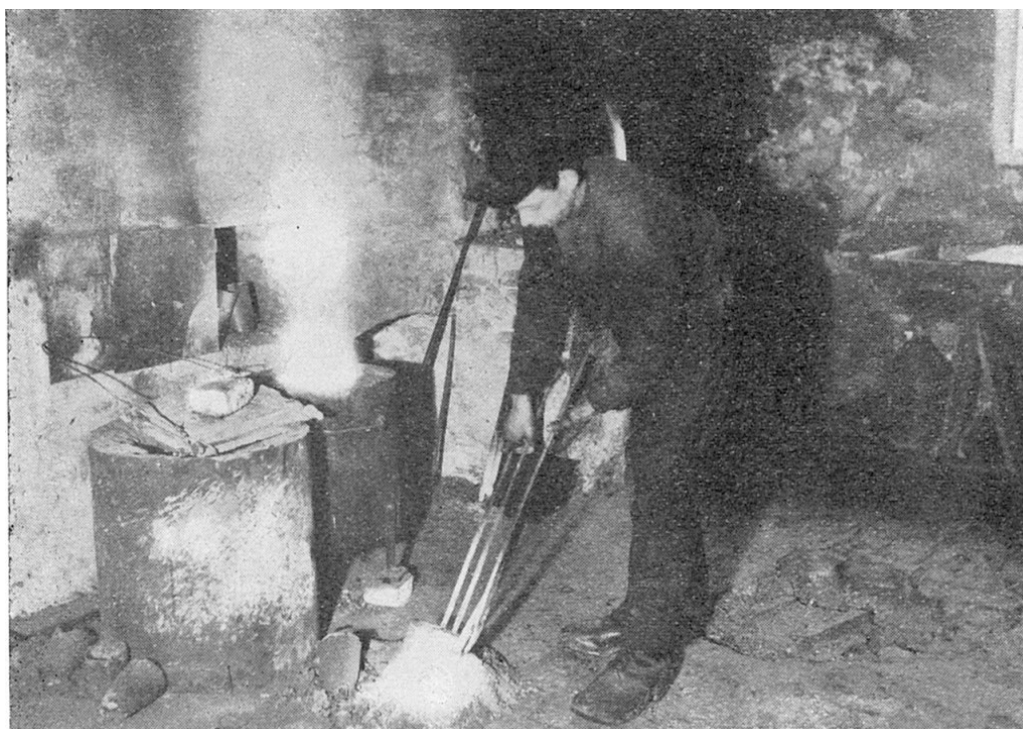
Det smeltede metall i diglen «skummes» for slag og urenheter.
