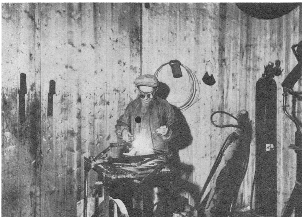
Fra sykkelreparasjonsverksted. Sykkelramme. Autogensveisning.
