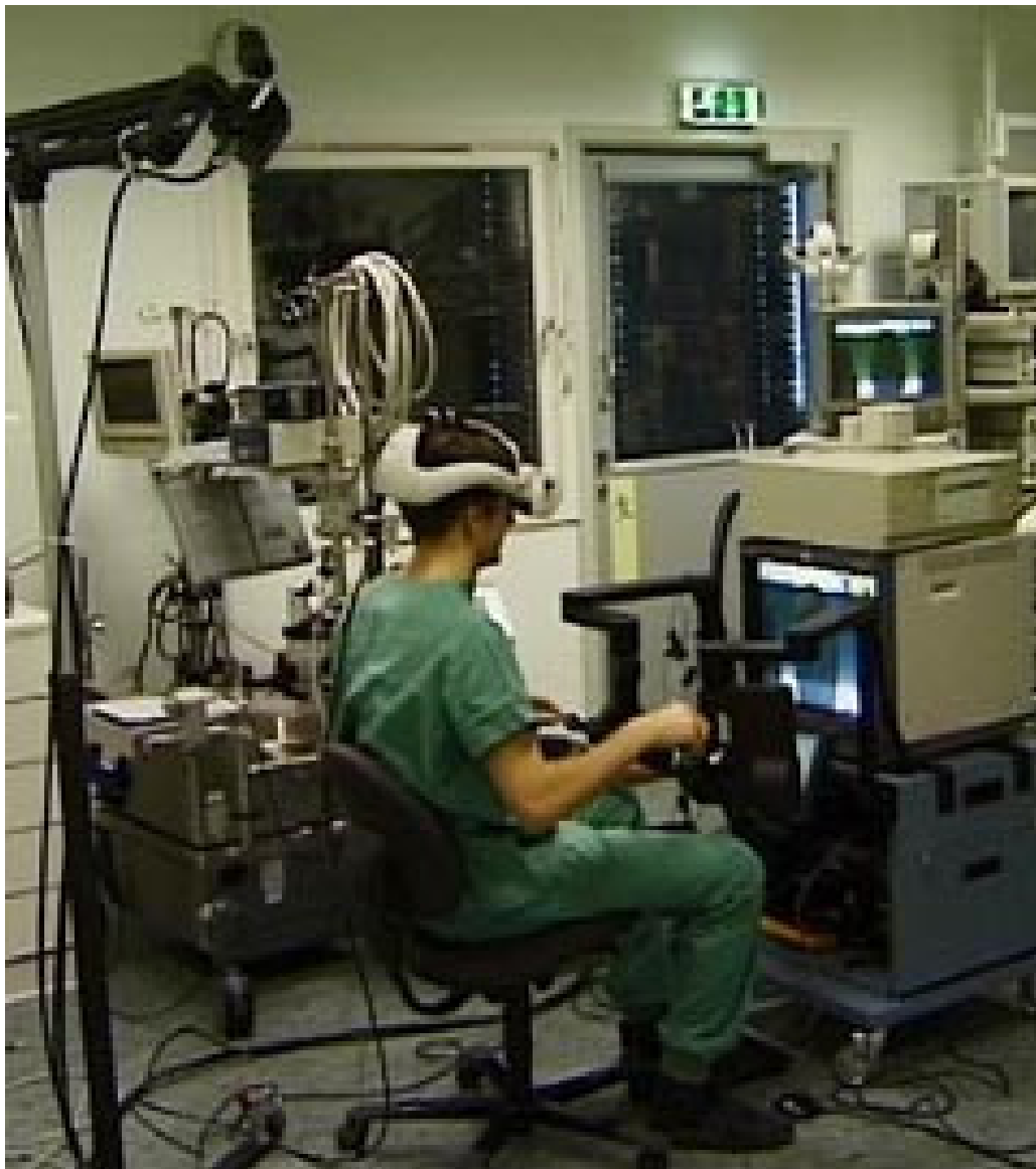
Figur 7 Operasjon med hodesporingsystemet. Tre kameraer over kirurgen monitorerer hodebevegelsene og overfører dem til Aesop-roboten
