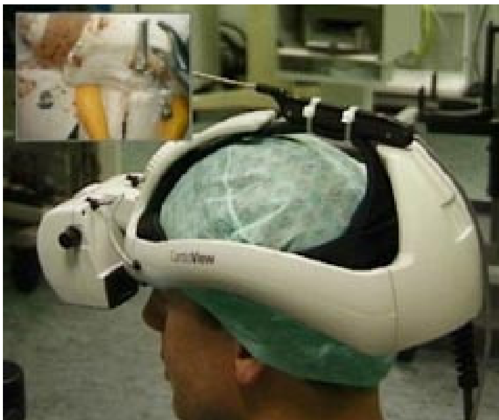
Figur 6 Lysdioder plassert på Vista-hjelm for hodesporing
